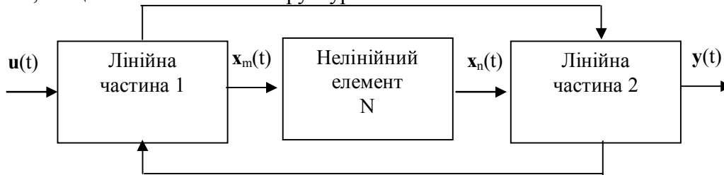
Рис. 1. Узагальнена схема нелінійної системи с одним нелінійним елементом
