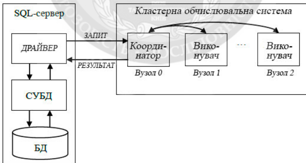
Рис. 1. Взаємодія SQL-сервера з кластерною обчислювальною системою
