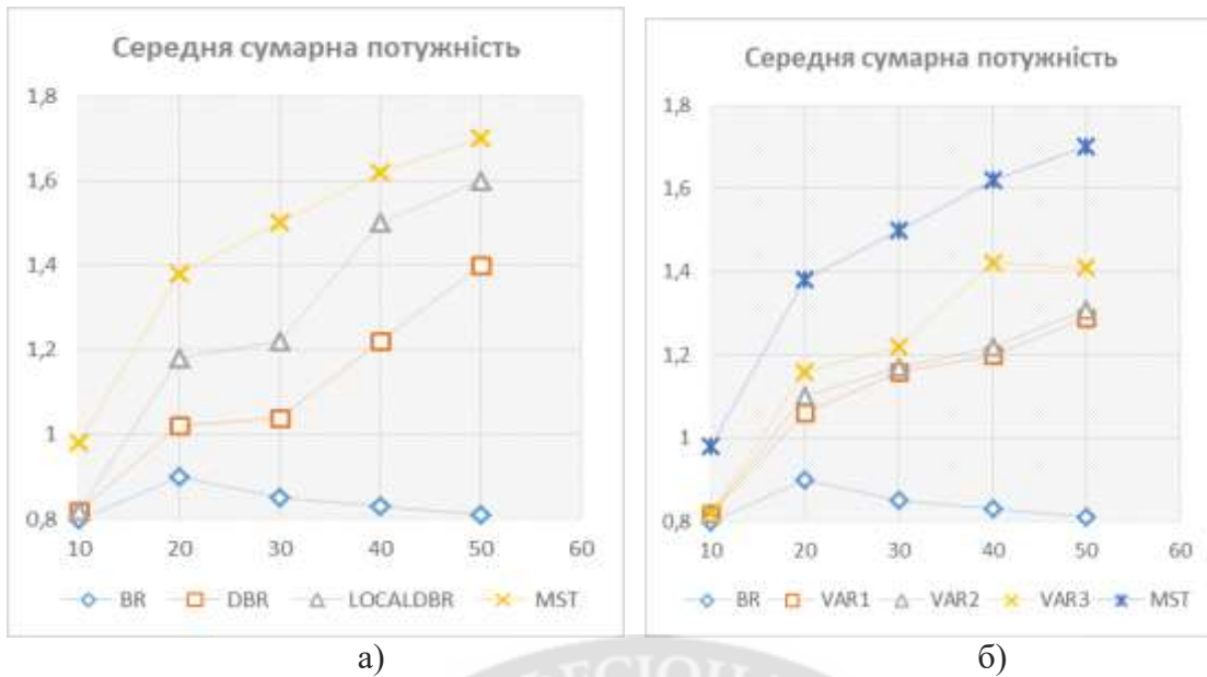
Рис. 4. Порівняння ефективності алгоритмів. По осі x – число вузлів в мережі. По осі y – сумарна потужність вузлів для мереж, отриманих алгоритмами а) з постійним рангом рефлексії; б) зі змінним рангом рефлексії
