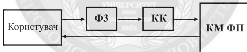
Рис. 4. Архітектура ВД з виділеним завантажувачем і контролером
