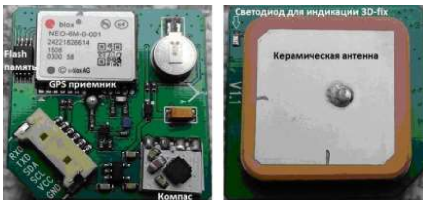
Рис. 5. GPS модуль u-blox NEO-6M с антенной, flash памятью и компасом
