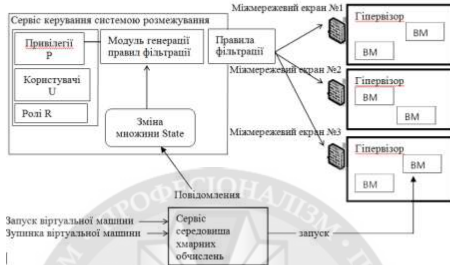
Рис. 2. Схема методу конфігурації правил фільтрації
