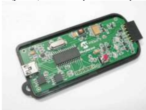
Рис. 3. Microchip PICKit, програмована налагоджувальна плата на базі мікроконтролера PIC18F2550. Тут використовується як зовнішній USB пристрій, що складається з однієї кнопки, що підключається по протоколу HID
