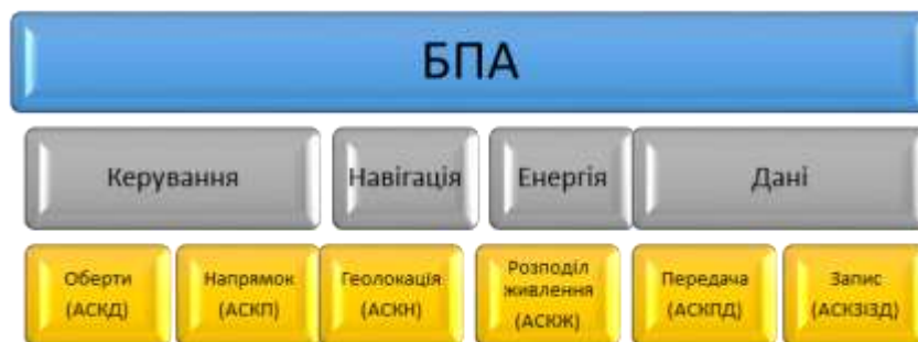
Рис. 1. Склад підсистем системи керування мережею БПА
