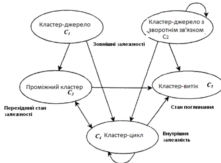
Рис. 1. Приклад мережевої структури зі зворотними залежностями
