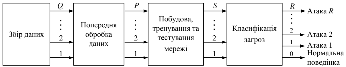
Рис. 2. Процес обробки даних та виявлення інцидентів кібернетичної безпеки з використанням штучної нейронної мережі
