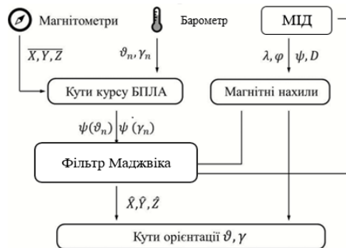
Рис. 2. Схема комплексування систем орієнтації і навігації БПЛА
