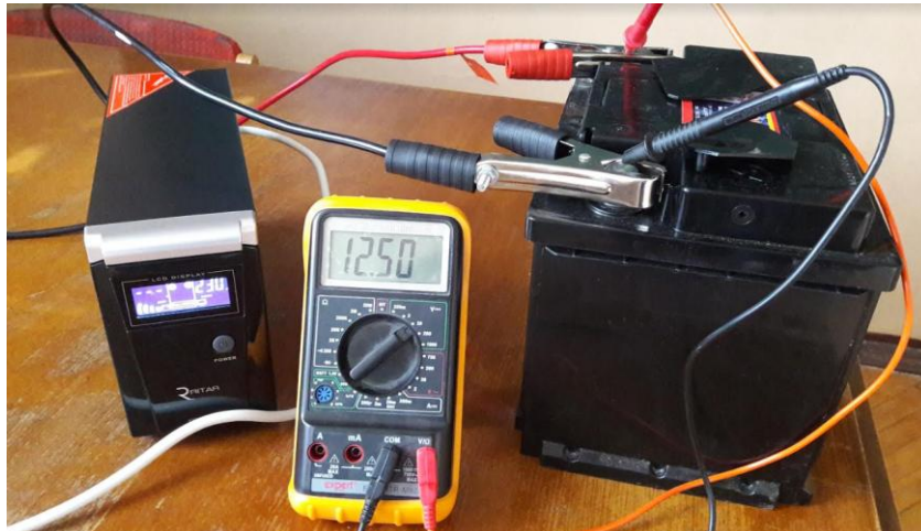
Рис. 2. Фото лабораторного зразка автономного живлення обладнання зв'язку 802.11xx
