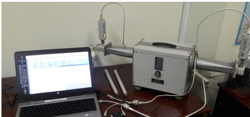
Рис. 3. РРЛ на основі прийомопередавачів Mikrotik Groove A-52HPn та атенюатора
