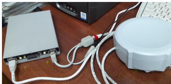
Рис. 4. Криптозахищеної лінії безпроводового зв'язку на основі Mikrotik SXT Lite5 та шифратора IP-трафіку CryptoIP-448
