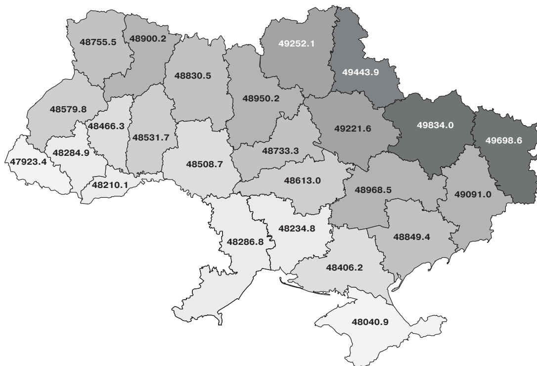
Рис. 5. Значення модуля індукції магнітного поля для областей України і АР Крим, за 1961 р.
