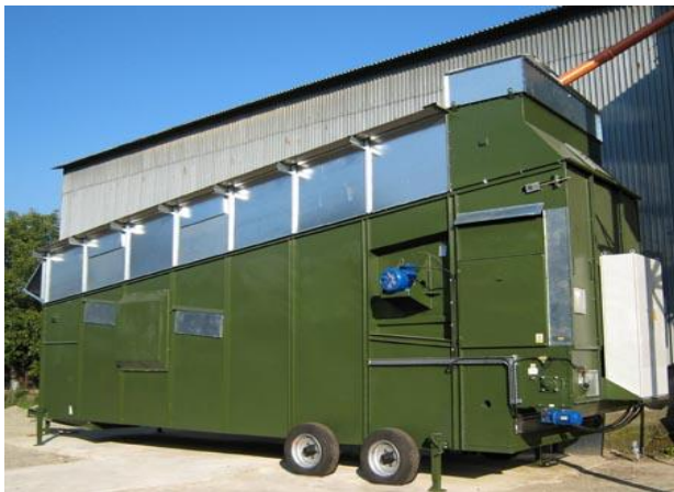
Рис. 3. Мобільна конвеєрна двохпотокова зерносушарка.
