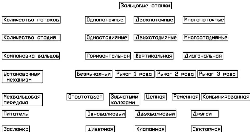
Рис. 1. Классификация вальцовых станков.
