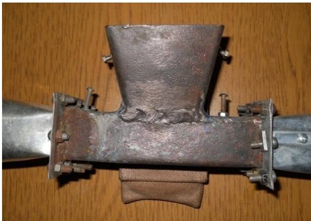
Рис. 1 – Схема та фото ежекційного пристрою
