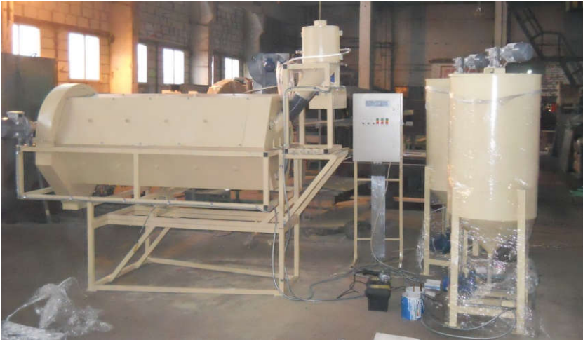
Рис. 12 - Машина для предпосевной обработки семян (ПСФ) Протравливатель семян Фадеева (ПСФ)
