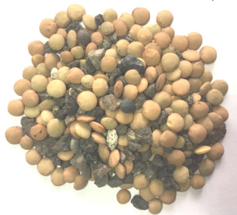
Рис. 13 – Смесь камушков и чечевицы, сошедшая с «тяжелого берега» пневмовибростела
