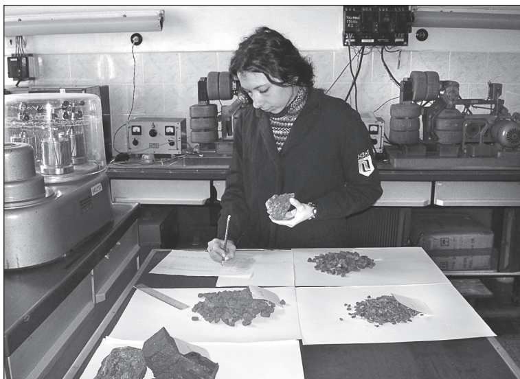
Рис. 1. Рудорозбирання проби вихідної руди у вузьких класах крупності
