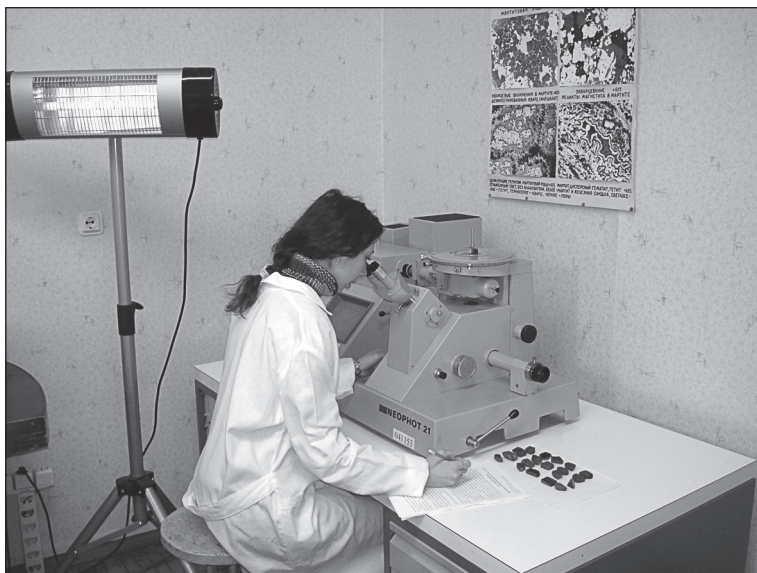
Рис. 2. Вивчення полірованих шліфів у відбитому світлі на мікроскопі Neophot 21
