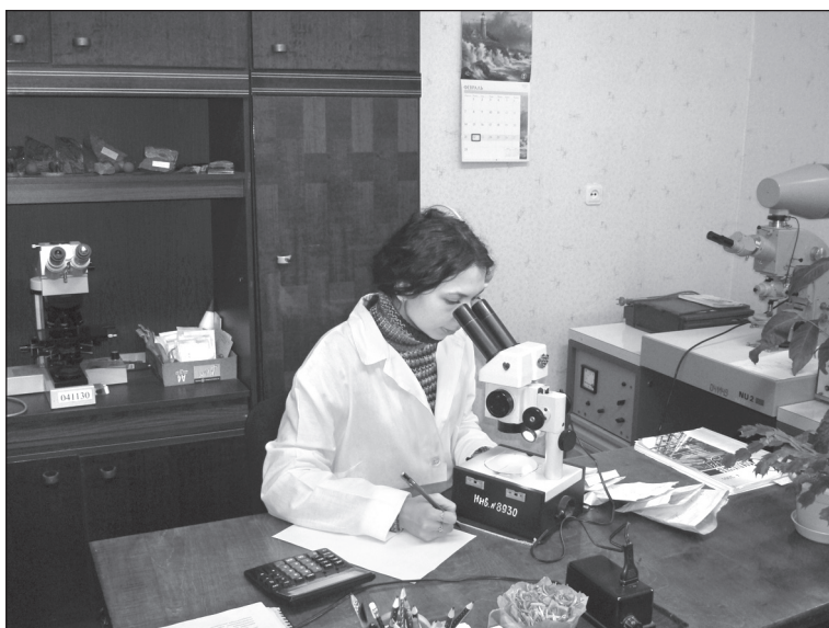
Рис. 3. Визначення розкриття мінеральних зерен під бінокулярном
