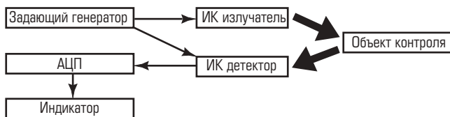
Рис. 2. Принципиальная схема инфракрасного эходефектоскопа
