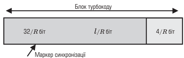
Рис. 4. Схема результуючого блока турбокоду (див. рис. 2) із прикріпленням маркером синхронізації: l — довжина блока інформаційних даних; R — заявна швидкість кодування
