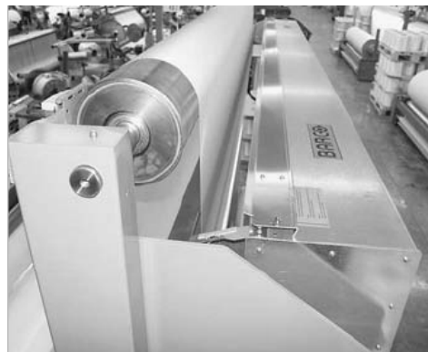
Рис. 2 Автоматизированная система Cyclops (фирма Varco) для проверки ткани на ткацком станке
