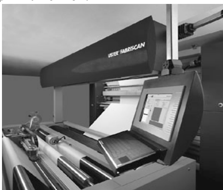
Рис. 1 Система Fabriscan (фирма Zellweger Uster) для обнаружения и классификации текстильных дефектов
