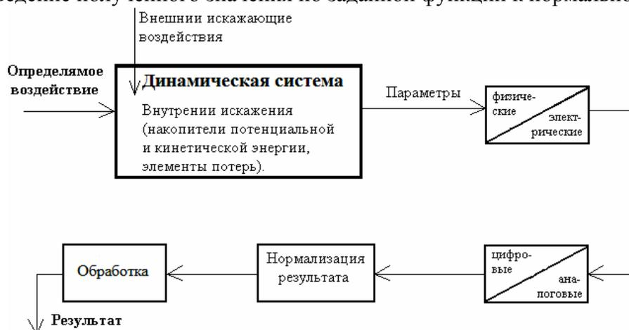
Рис. 1 Структурная схема получения параметра динамической системы
