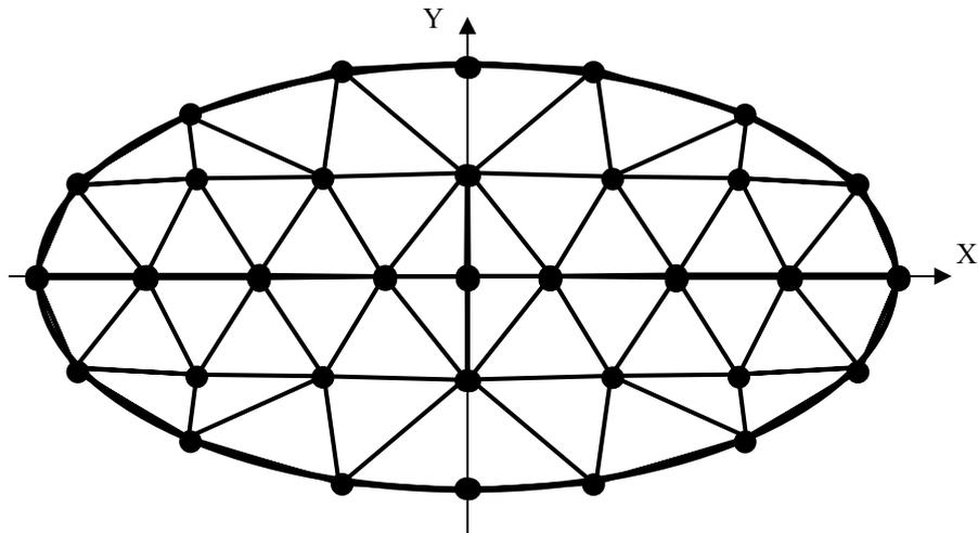
Рис. 1 Дискретизация эллипса сеткой конечных элементов
