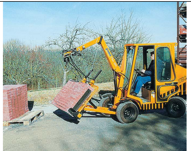
Транспортування блоків мощення обладнанням PC-VM-uni
