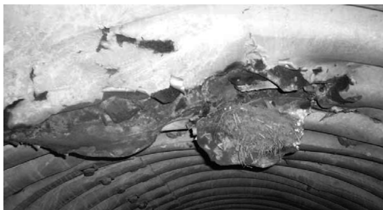
Рисунок - 5 Местный разрыв тела трубы
