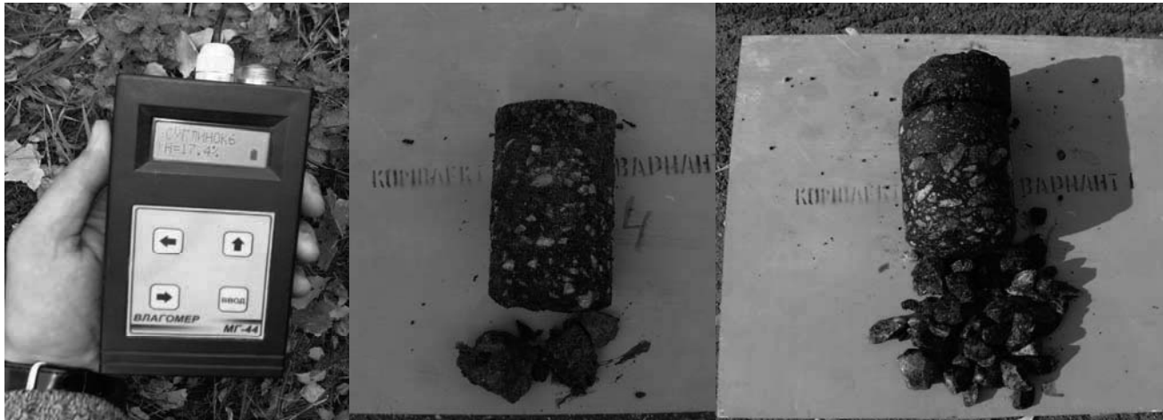
Рисунок 6 – Определение влажности грунтов на обочине на глубине 50 см; керны на марке № 3
