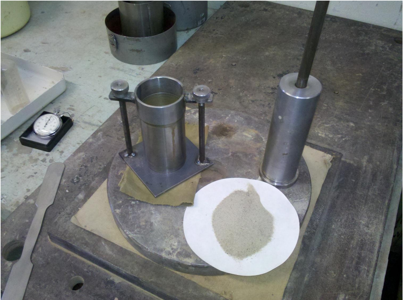
Рисунок 1 – Пристрій для ущільнення піску у фільтраційному циліндрі приладу КФ-ООМ
