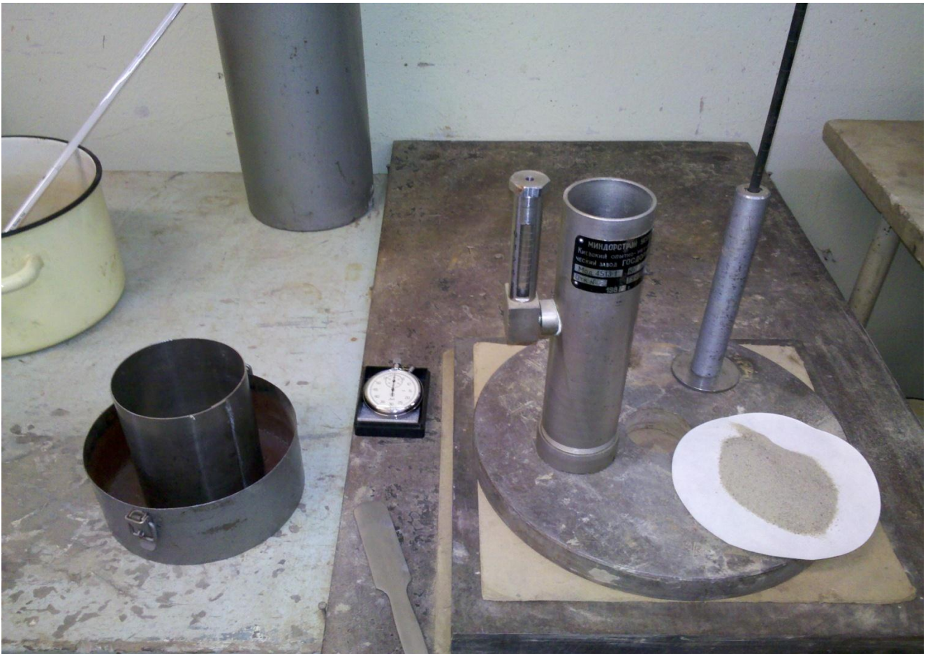
Рисунок 2 – Прилад конструкції В.С. Сиралева для фільтраційних випробувань ущільнених зразків піску
