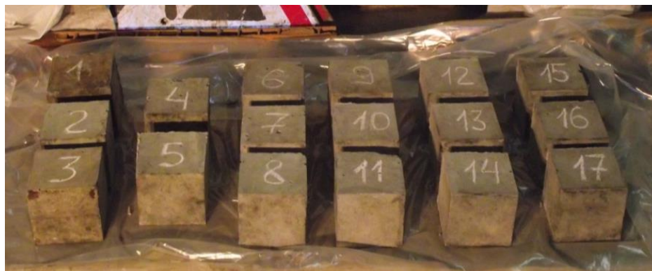
Рисунок 2 – Визначення міцності бетону на стиск руйнівним методом
