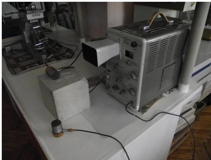
Рисунок 3 – Визначення швидкості розповсюдження хвилі стиску на контрольних зразках-кубах з цементного бетону
