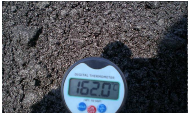
Рисунок 7 – Температура суміші на початку ущільнення не відповідає діючим вимогам
