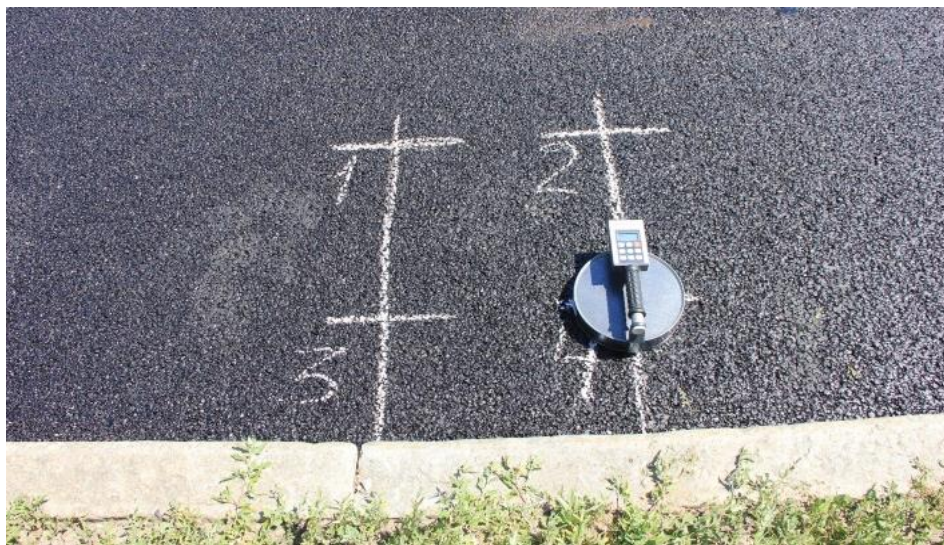
Рисунок 3 – Визначення щільності асфальтобетону приладом ПАБ-1.0
