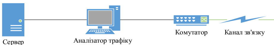
Рис. 2. Розміщення аналізатору трафіку в інформаційній мережі
