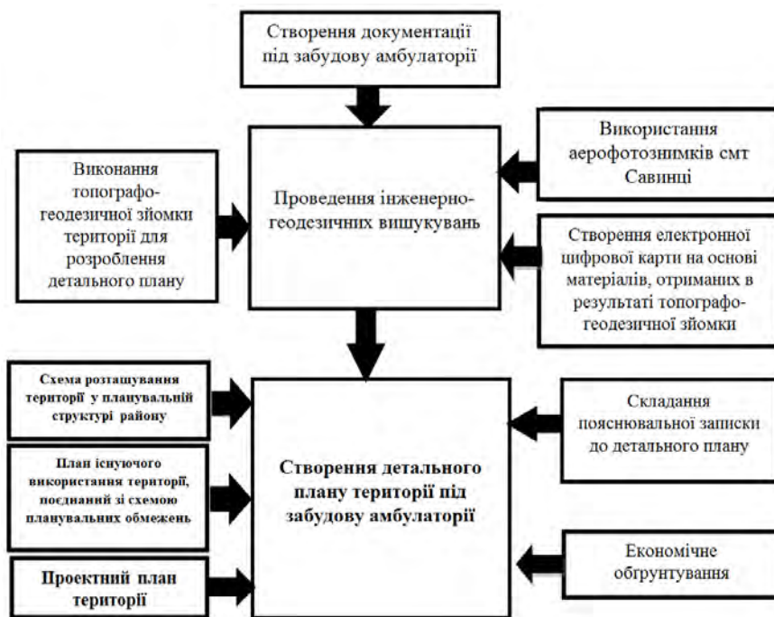
Рис. 7. Структурна схема методики розробки земельно-кадастрової документації ділянки під забудову об'єкту медичного призначення
