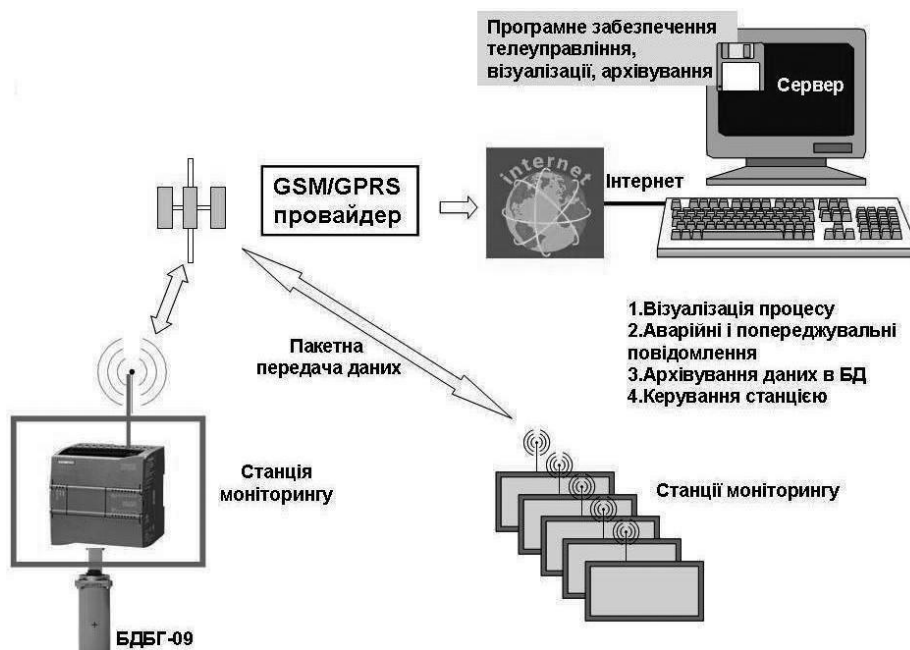
Рис. 2. Автоматизована система для цілодобового безперервного моніторингу радіаційного фону для декількох об'єктів
