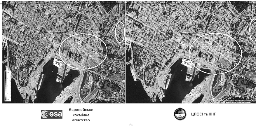
Рис. 12. Порівняльні інтерферометричні дослідження вертикальних зміщень залізничної станції у м. Осло. Виявлена швидкість просідання близько 15 мм. за рік
