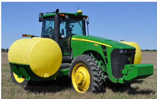
Рис. 10. Общий вид трактора с емкостью свыше 500 галлонов.
