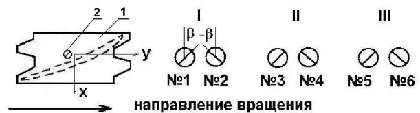
Рис. 1. Схема расположения датчиков для регистрации колебаний бандажированных лопаток; 1 – бандажная полка лопатки; 2 – магнит в немагнитном корпусе; № 1 – 6 – номера датчиков; I – III – номера пар датчиков
