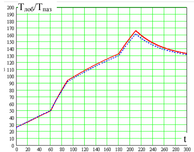
Рис. 3. Изменение температур лобовой и пазовой обмоток при отработке циклограммы
