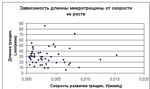
Рис. 1. Зависимость длины микротрещин от скорости их развития
