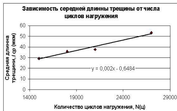
Рис. 3. Зависимость плотности трещин от количества циклов нагружения
