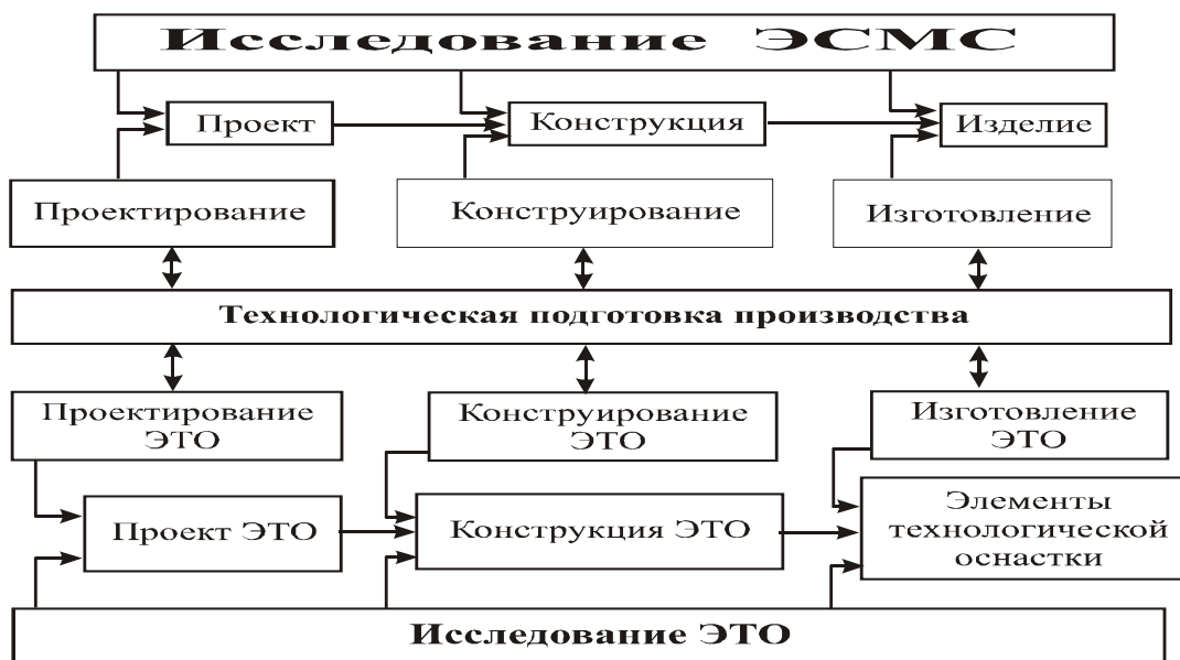
Рис. 2. Этапы создания изделия и элементов технологической оснастки (ЭТО) для его изготовления
