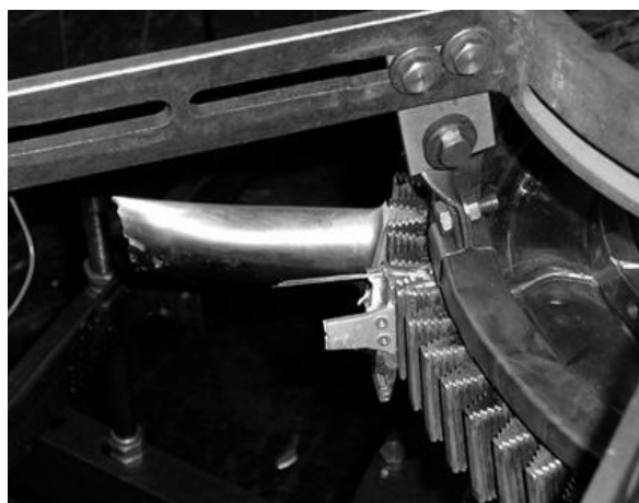
Рис. 3. Рабочее колесо ГТД с двумя штатными лопатками после обрыва двух ослабленных лопаток
