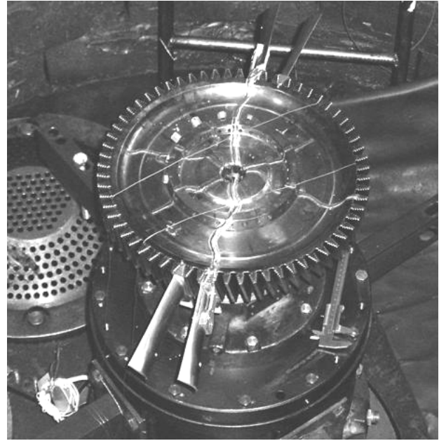
Рис. 2. Рабочее колесо ГТД с двумя ослабленными лопатками и элементами устройства обрыва и двумя штатными лопатками перед испытаниями
