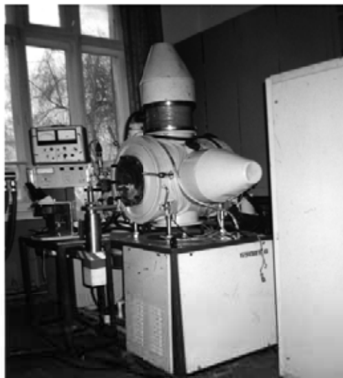
Рис. 1. Лабораторна модульна установка, що трансформується, для нанесення покриттів та комбінованого зміцнення деталей та різучого інструменту
