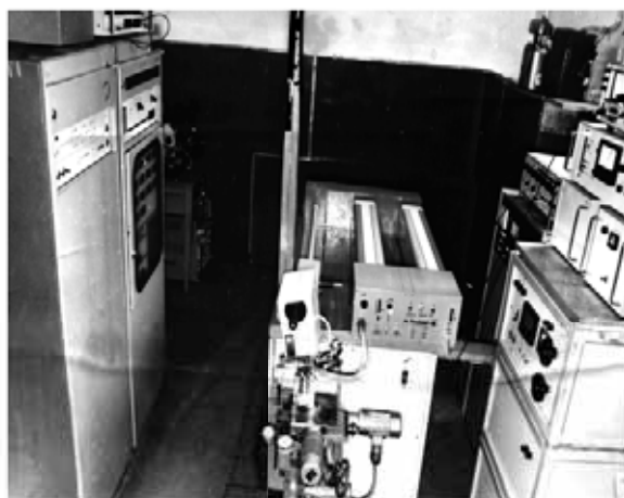
Рис. 9. Лазерна установка для обробки ріжучих пластин із полікристалічних надтвердих матеріалів (ПНТМ)
