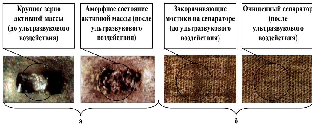
Рис. 7. Элементы никель-кадмиевого аккумулятора до и после воздействия ультразвуком (а – активная масса окисно-никелевого электрода с увеличением в 100 раз; б – сепаратор с увеличением в 50 раз)
