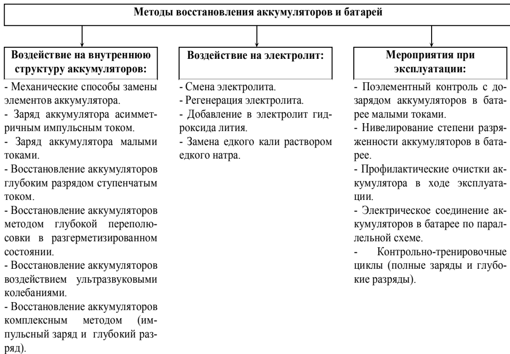
Рис. 4. Методы восстановления аккумуляторов и батарей
