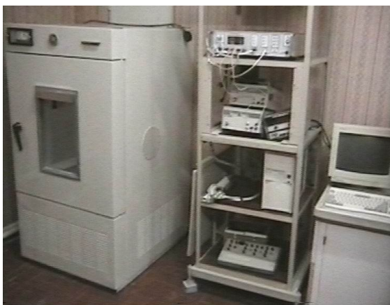
Рис. 12. Стенд для ресурсных испытаний электрохимических аккумуляторных батарей
