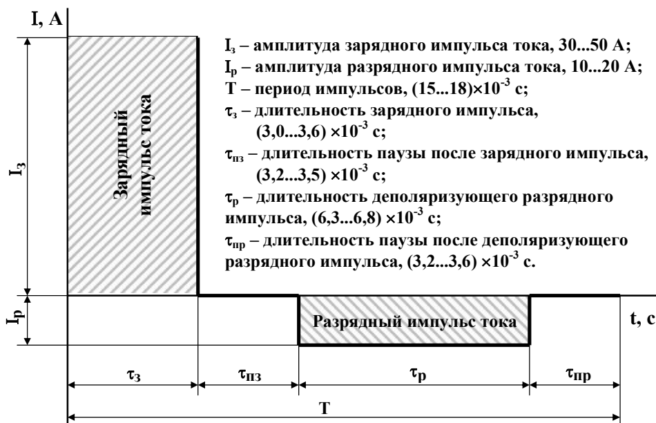
Рис. 5. Форма асимметричных импульсов при восстановлении емкости аккумуляторов
