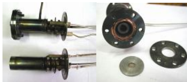
Рис. 1 Лабораторная модель катода с блоком сменных диафрагм
