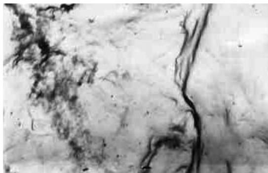
Рис. 2. Микрофрактограмма усталостного излома образца с напылением и последующим выглаживанием – 4000 x
