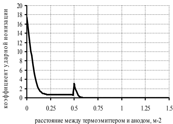
Рис. 5. Изменение коэффициента ударной ионизации \alpha по длине промежутка по мере формирования тлеющего разряда
