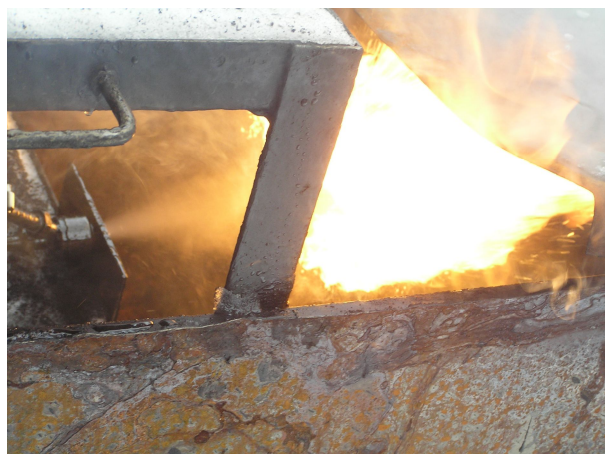
Рис. 8. Сжигание ИКЖТ с помощью форсунки
