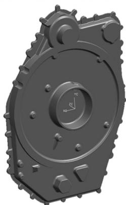
Рис. 3. Модель отливки (заготовки) после доработки конструктором оснастки
