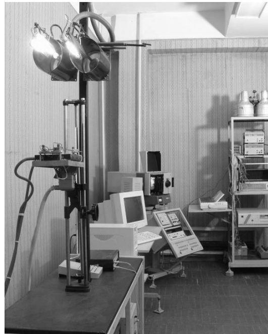
Рис. 2. Установка для испытаний и сертификации фотопреобразователей
