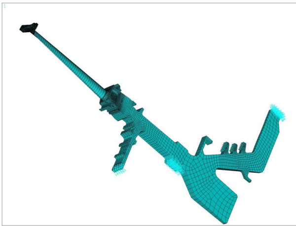
Рис. 1. Конечноэлементная модель сектора рабочего колеса
